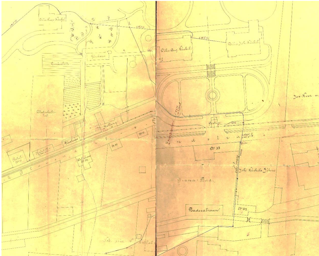
Rozvody dálkového parního topení a vody ... 1924
